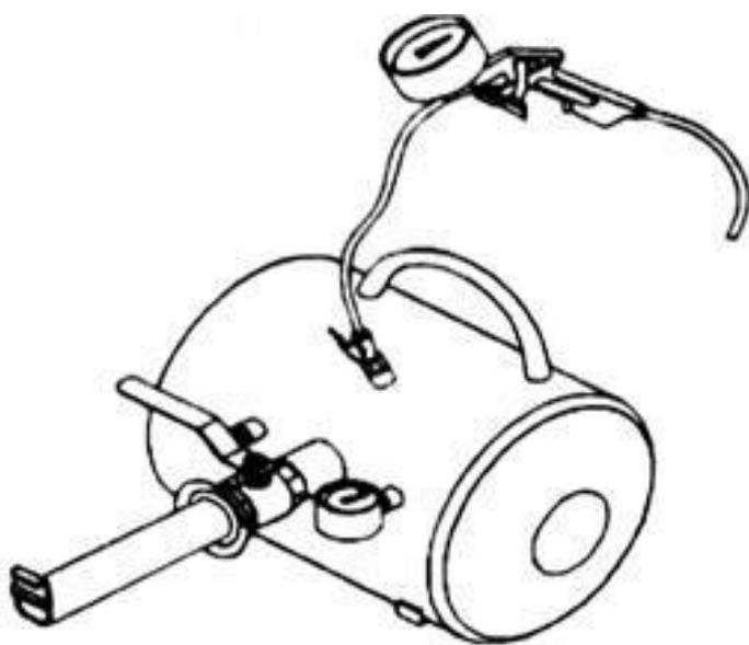
3. Рисунок 1 – Используя компрессор – заполните ёмкость ресивера, до момента открытия клапана сброса давления.
